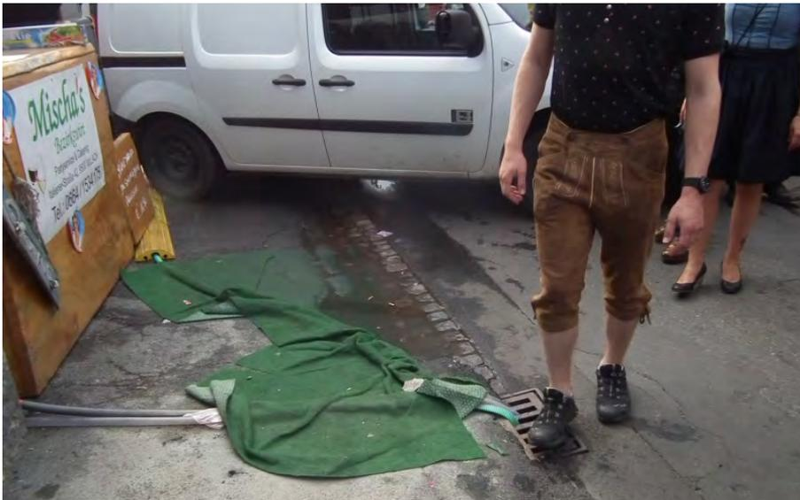
Abb. 15: verschobene Matten über Leitungen als Stolperfallen (2011)
